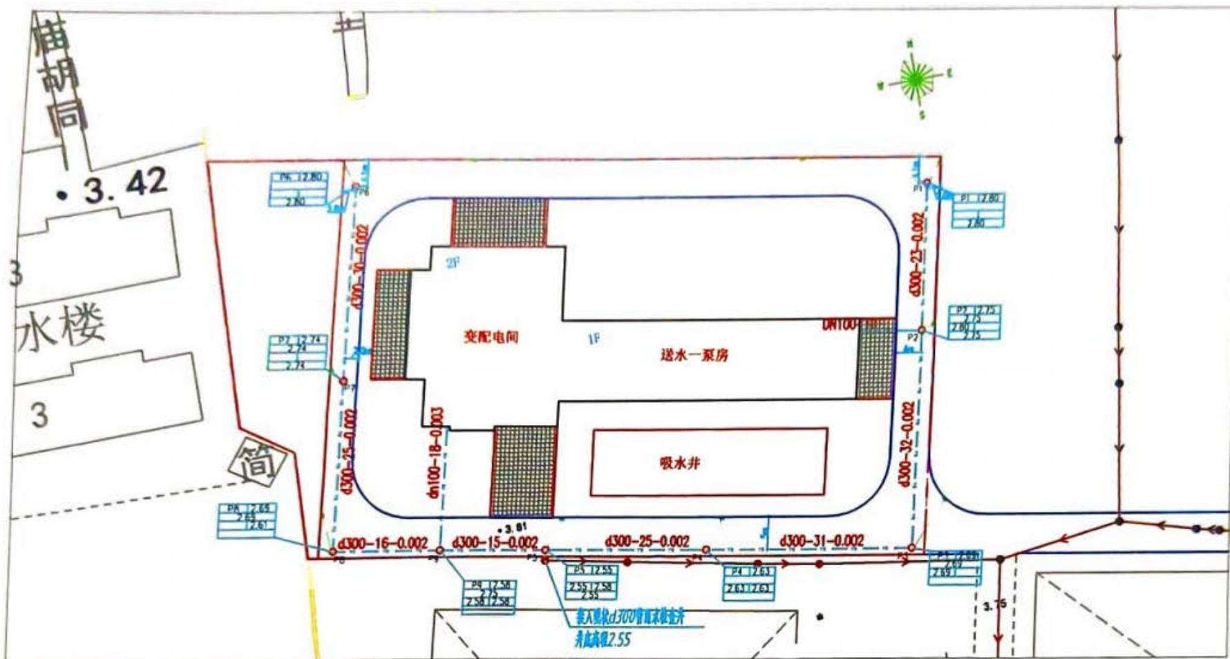
附图6 新建送水一泵房排水管线图
