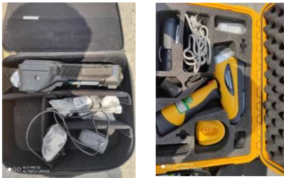
图 5-7 现场快速检测仪（左 PID 右 XRF）
