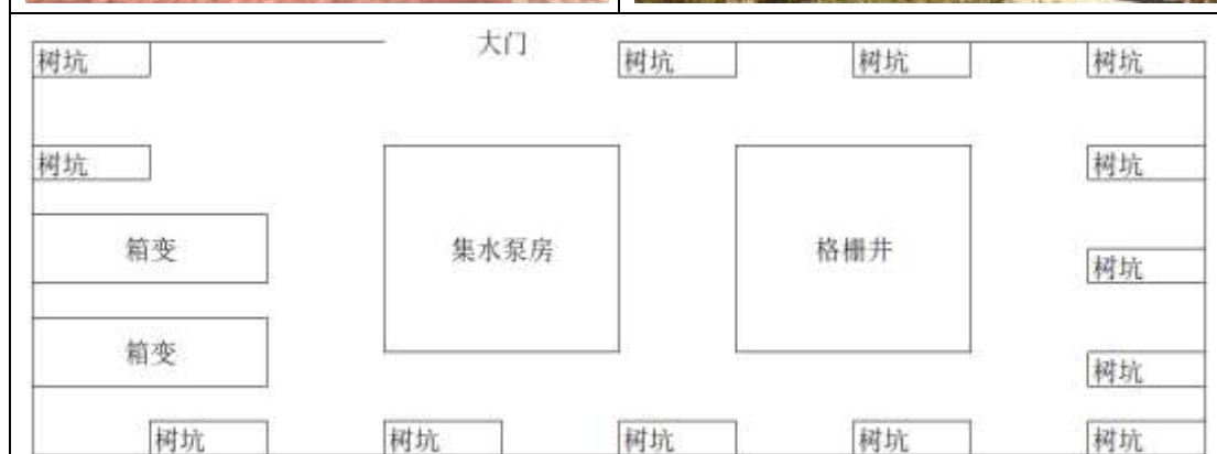
3#污水提升泵站现状及平面图
