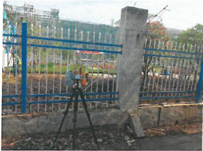
附 2: 废气(无组织)现场采样照片 下风向无组织监控点 3#
