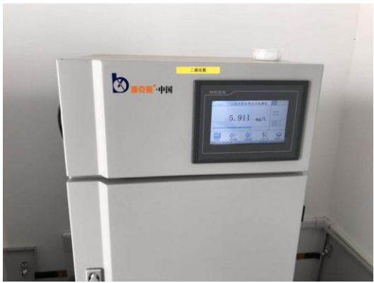
图10 二期总氮在线监测设备
