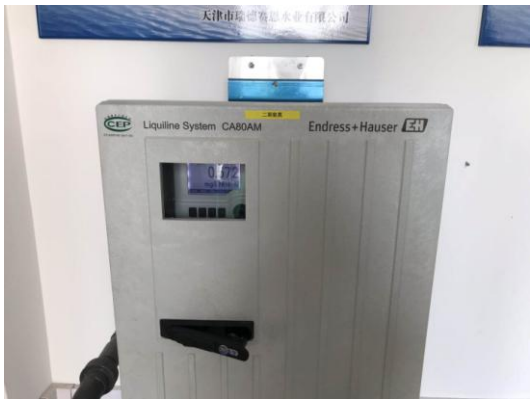
图9 二期氨氮在线监测设备
