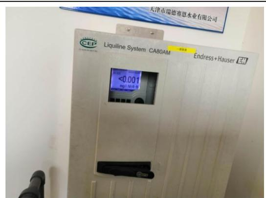
图 29 氨氮在线监测设备
