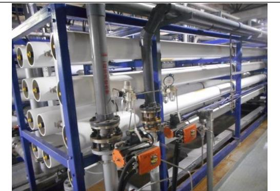
图 4 浓水反渗透装置
