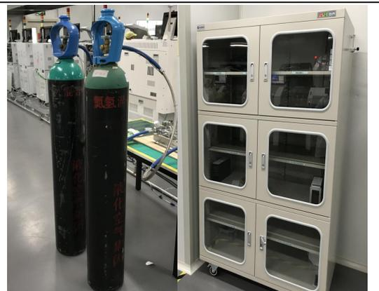
图 2 氮气瓶及氮气柜
