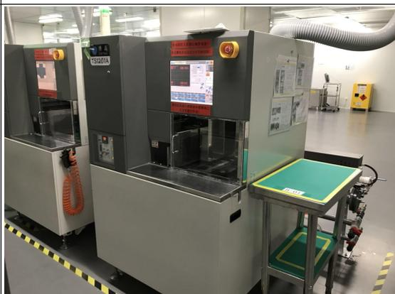
图 6 切割机（含清洗工序）
