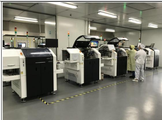
图 1 芯片键合设备（固晶机）
