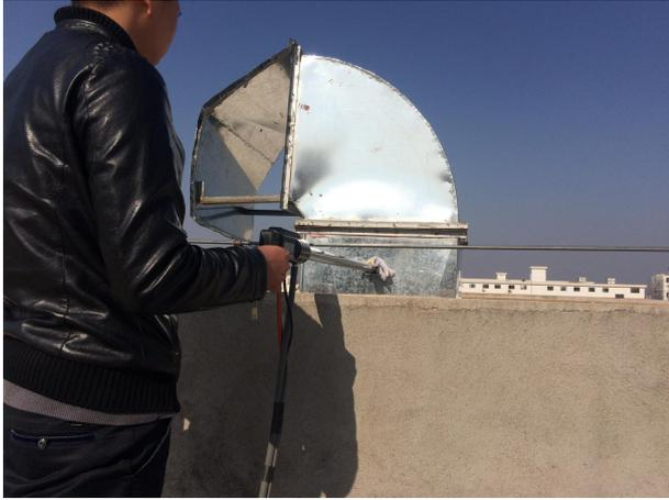
分装工序废气监测
