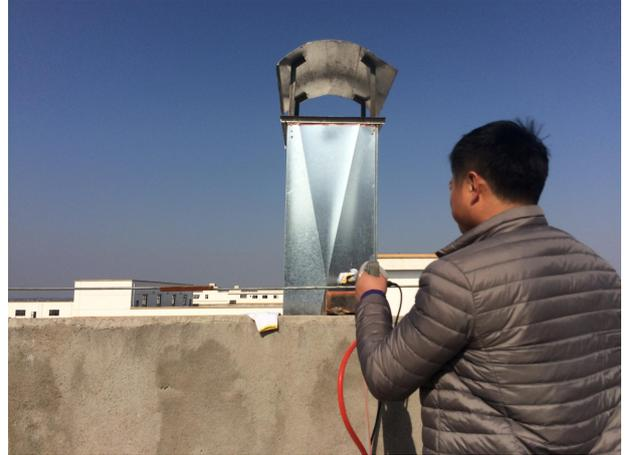
粉碎、干燥工序废气监测
