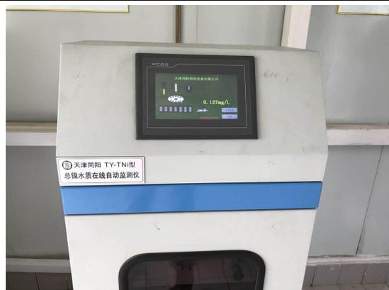
图 11 总镍水质在线自动监测仪
