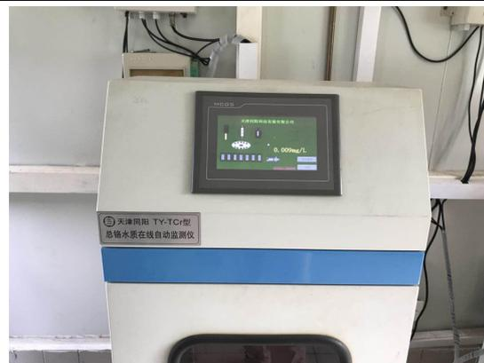
图 12 总铬水质在线自动监测仪
