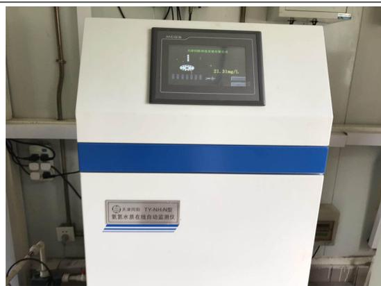
图 9 氨氮水质在线自动监测仪
