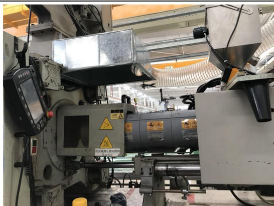
图 1 注塑设备集气罩
