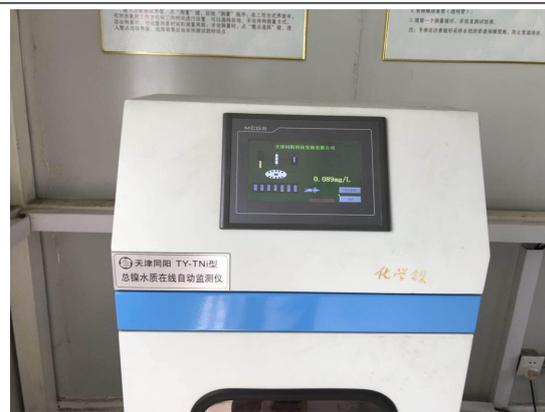
图 10 化学镍水质在线自动监测仪
