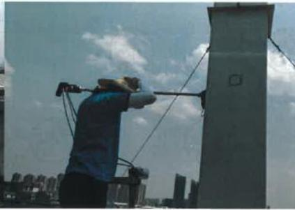
II 实验废气排气筒处理后采样口
