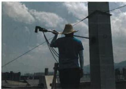
III 实验废气排气筒处理后采样口
