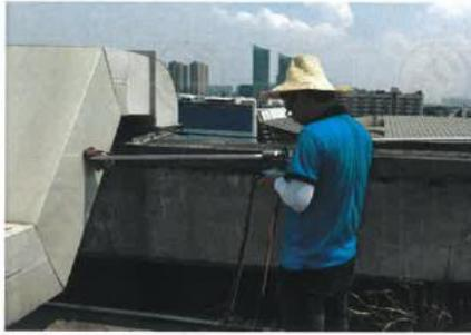
II 实验废气排气筒处理前采样口
