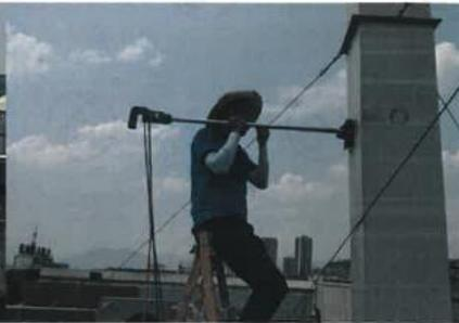
VI 实验废气排气筒处理后采样口
