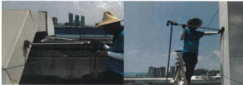
I 实验废气排气筒处理前采样口
