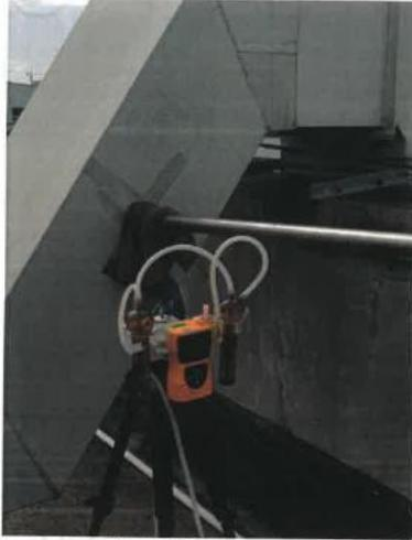
II 实验废气排气筒处理前采样口
