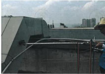
V 实验废气排气筒处理前采样口
