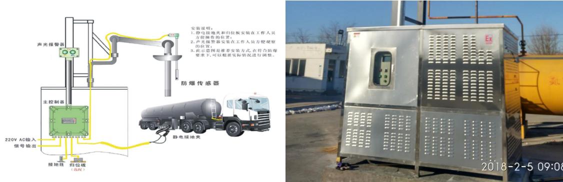
图 1 油气回收装置工作原理图
