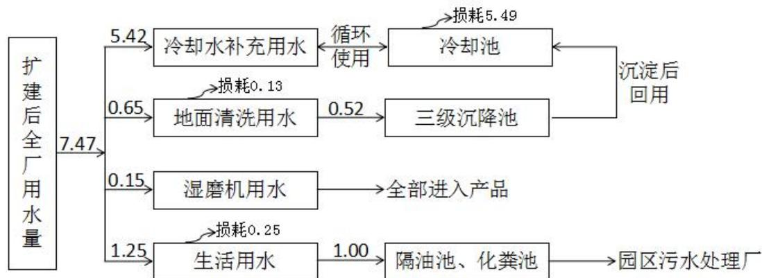
图 3-1 项目水平衡图 (t/d)
