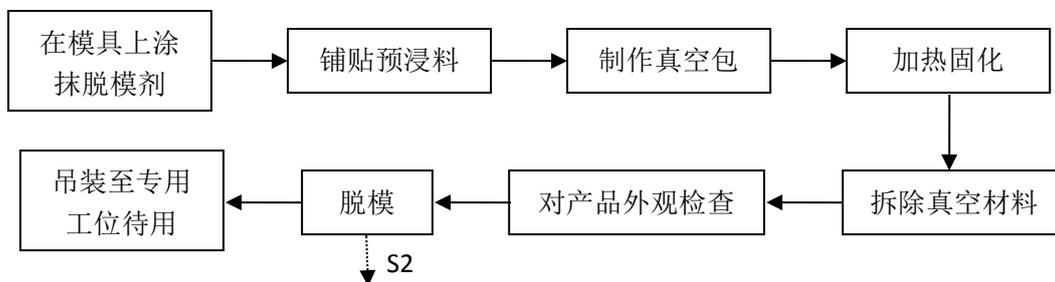
图 3.7-1 龙骨生产线流程图
