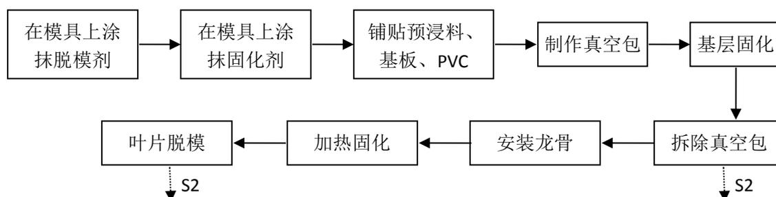
图 3.7-2 叶片生产线流程图
