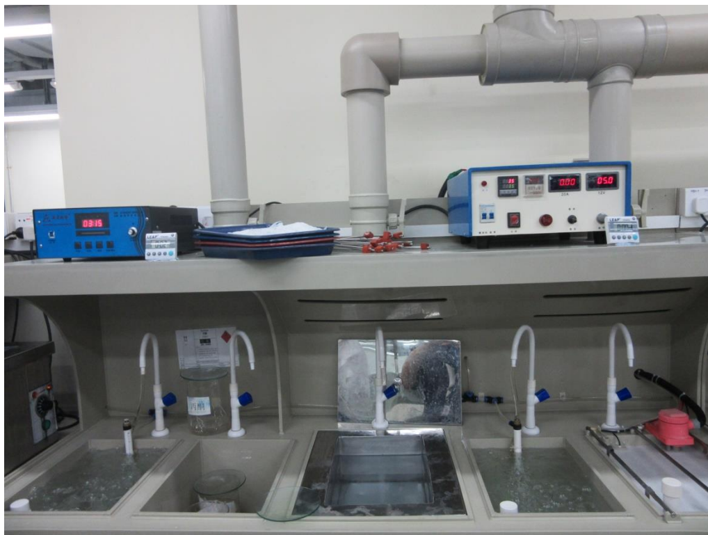
图 21 电金、清洗工序
