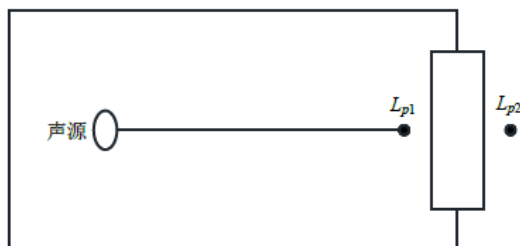
图 4-1 室内声源等效为室外声源图例
