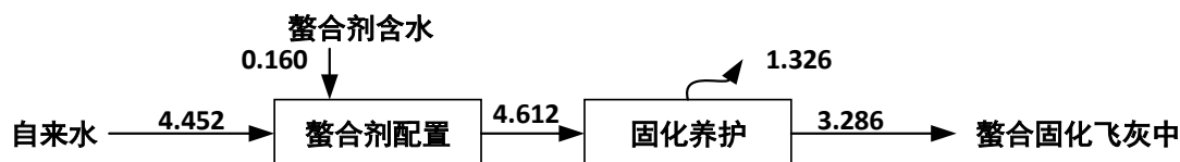
图 3.2-1 本项目水平衡图 (m 3 /d)
