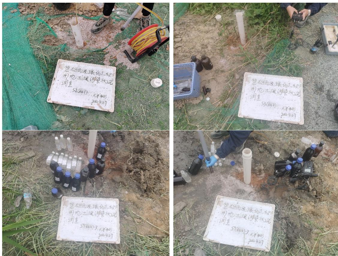
图 3.2-2 现场取水样及快速检测照片
