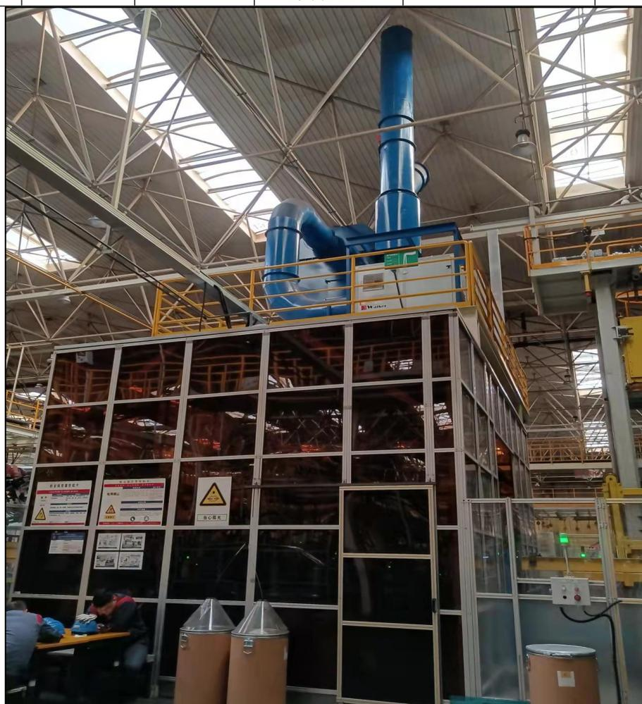
图 3 焊装二线设置的焊接间及排气筒 DA056
