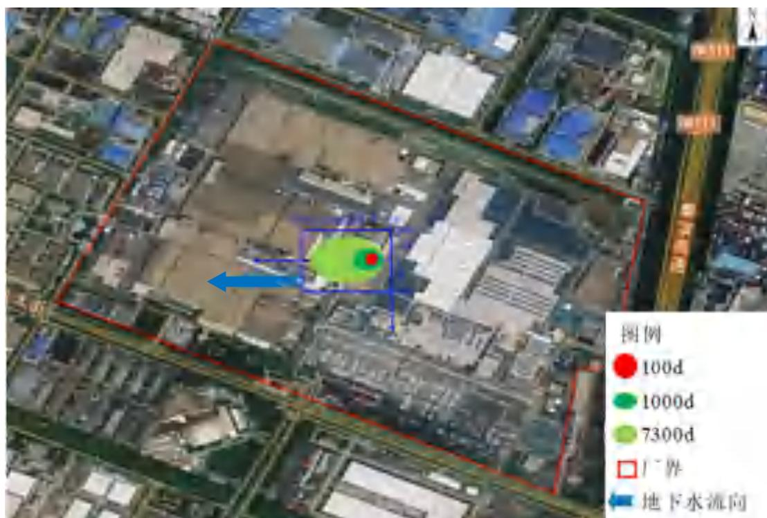
图 6.5-3 新一线废水处理站废水调节池非正常状况泄漏后总锌影响（检出限）范围预测图
