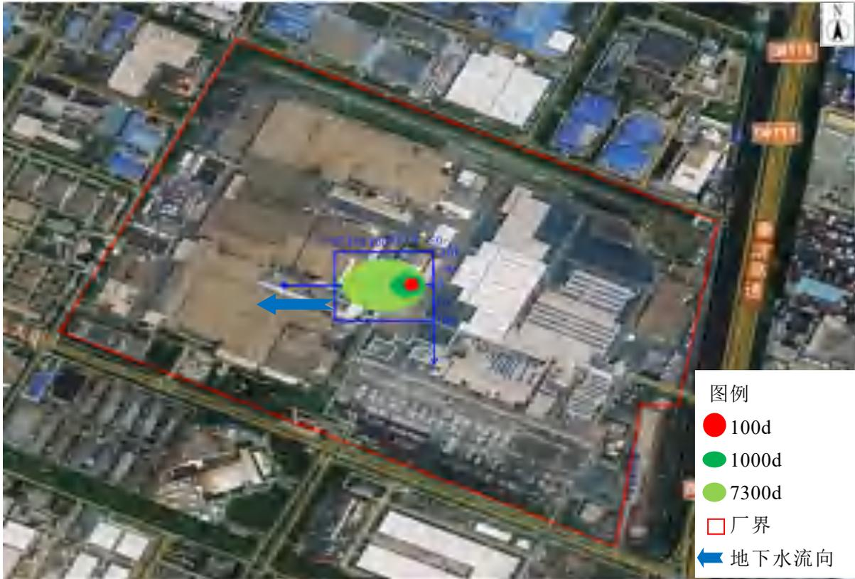
图 6.5-1 新一线废水处理站废水调节池非正常状况泄漏后石油类超标（III类）范围预测图
