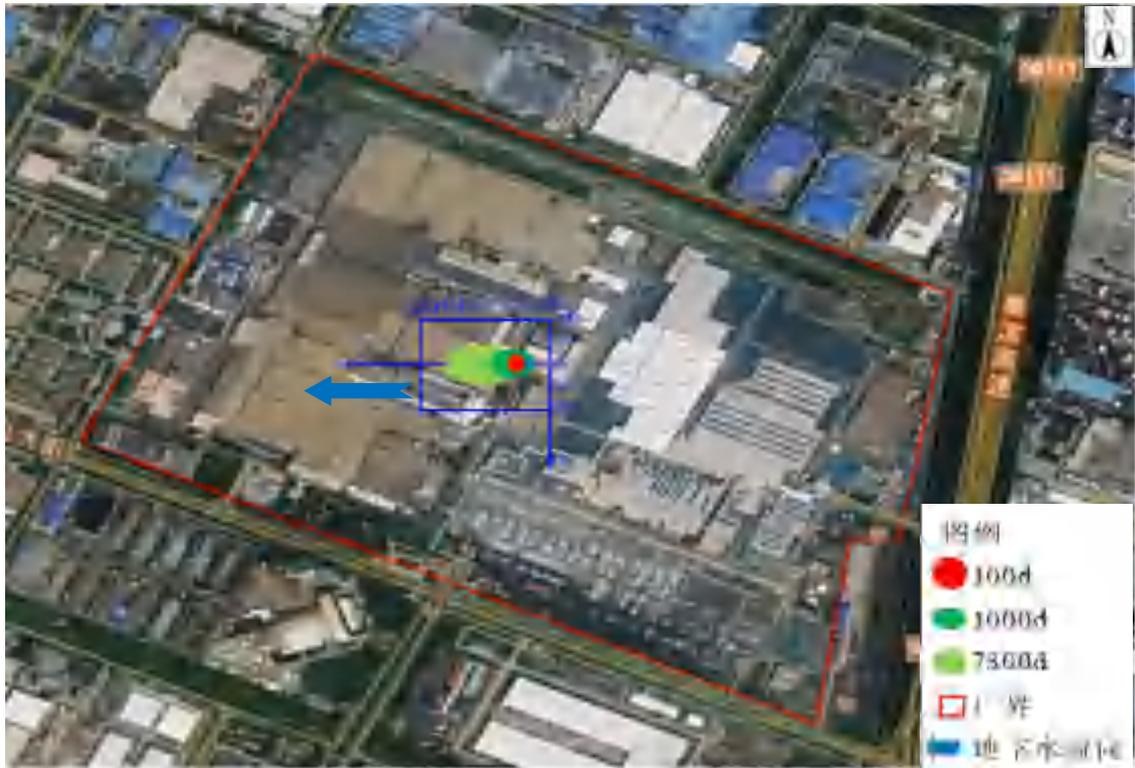
图 6.5-4 三工厂磷化废水处理站调节池非正常状况泄漏后总镍超标（III类）范围预测图
