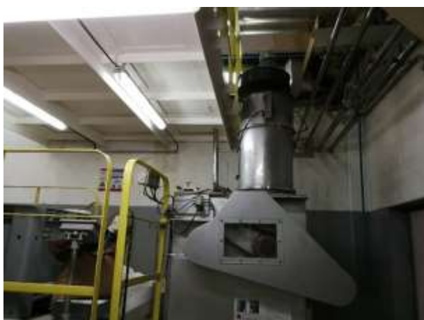
图 5-2 人工操作平台吸尘装置
